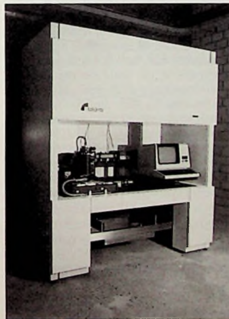
Bild 3: Der Laser-Pattern-Generator personalisiert die vorgefertigte Metallgitterstruktur durch Belichten und anschließendes Ätzen
