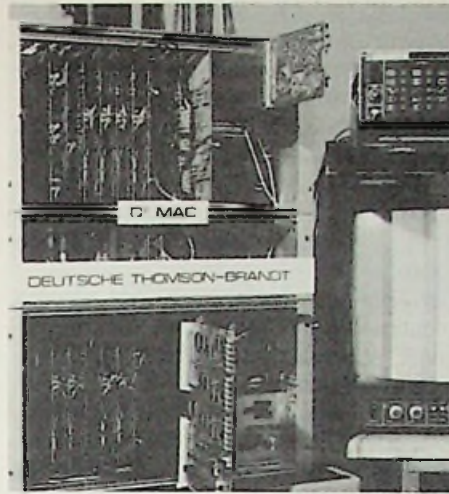
Bild 1: D2-MAC-Decoder im Labor der Deutschen Thomson-Brandt: Jetzt gibt es von Intermetall die Schaltung „auf Silizium“ (Foto: DTB)
