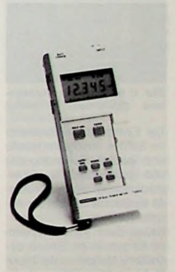
Bild 1: Handliches Meßgerät zum Messen der Strahlungsleistung von Lichtquellen (Rohde & Schwarz-Presebild)
