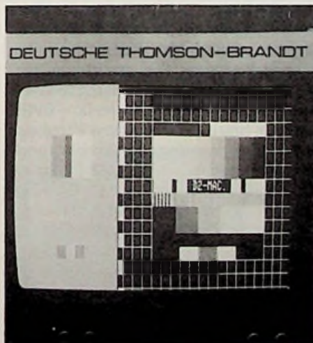
Bild 2: Links Ton und Daten, dann die Farbe und schließlich die Helligkeit – in dieser zeitlichen Folge kommen künftig D2-MAC-Signale beim Empfänger an, und der macht dann die gute Qualität (Foto: DTB)
